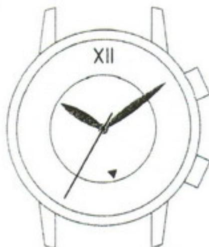
Dos coronas e indicador (forma triangular) del despertador o avisador de pulsera, situado, en este caso, entre las cinco y las seis horas.
