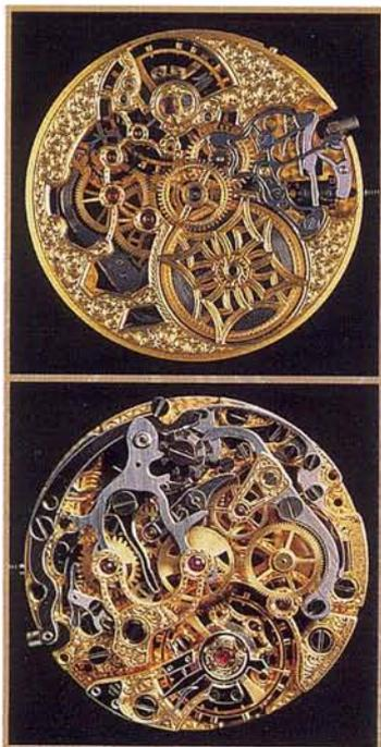
Su autonomía de marcha es de 48 horas y el armado del muelle real es manual, por la corona. Sus ruedas y móviles que lo hacen funcionar giran sobre rubíes con un total de piedras de 21, muy adecuado a la calidad que se pretende.
