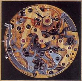
Para efectuar estas mediciones parciales, el reloj lleva otro pulsador al efecto. El armado del muelle real o cuerda es manual y su autonomía de marcha es de 48 horas, con 23 rubíes.
