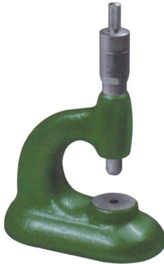
*En la foto vemos la potencia con tornillo micrométrico, de graduación 0,002mm.*
