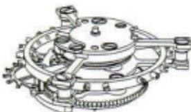
En el carrusel del dibujo sólo giran las partes que se han mencionado anteriormente para el dispositivo original del "Tourbillon", pero se aprecia bien la diferente posición de los elementos, si se comparan con el sistema que patentó Breguet en 1801.
