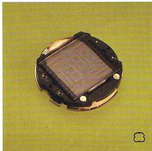
La pantalla o «display» de cristal líquido L.C.D. se mantenía fija en su posición mediante una platina metálica que a su vez hacía
