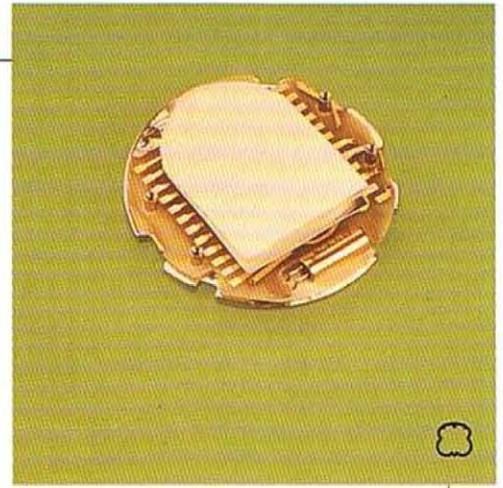
Para concluir este pequeño resumen, vemos en la fotografía adjunta una pantalla o difusor que, colocado debajo del «display» conduce hacia arriba la luz de una pequeña lámpara que nos permite leer la información en lugares oscuros y por la noche.
