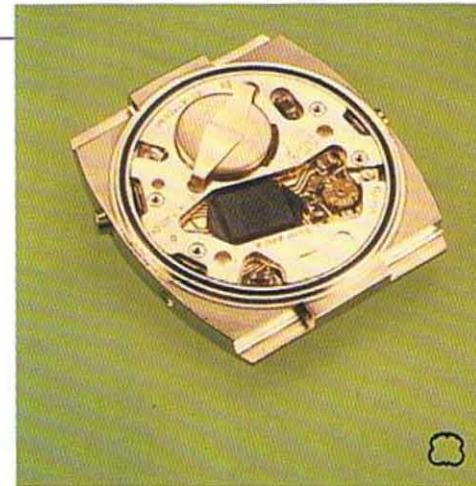
El reloj, sin la tapa, muestra la pila con su brida de sujeción, el circuito integrado en el centro, negro, y el «trimmer» a su lado. No se aprecia en la foto el cristal de cuarzo por su disposición en el circuito.
