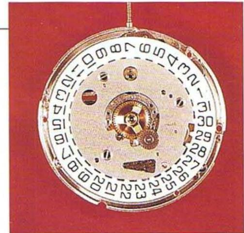
Se aprecia en la foto el sistema de la función calendario del reloj Diapason; es un disco dentado comandado por el cañón de horas, o rueda de horas central.
