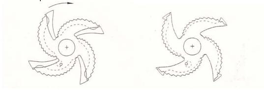
Este sistema evita que después del salto de la estrella de 12 o sea después de una nueva hora. El mecanismo no vuelva a indicar, tres cuartos o 14 minutos.
