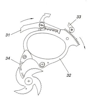
Después de la puesta en marcha, el gancho de arrastre de los minutos, libera la pieza de los minutos, que efectuará un desplazamiento determinado por su palpador (34), que recogerá la información sobre el caracol o contadora de los minutos.
