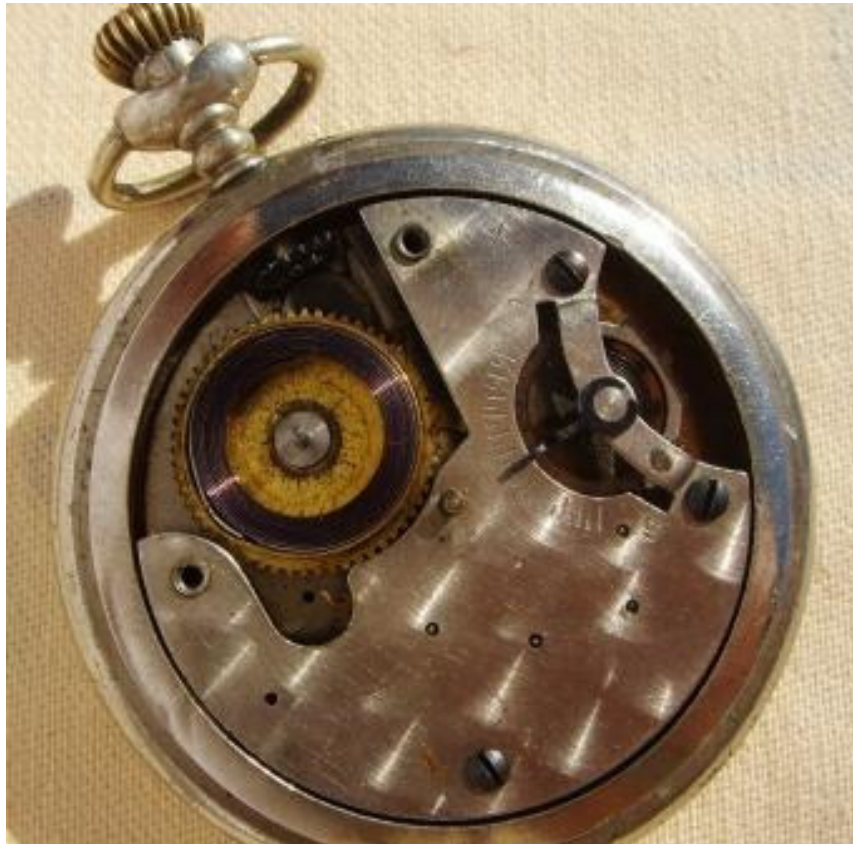
Fig. 6 – Muelle real roto en un reloj americano antiguo. Este barrilete no utiliza tapa.
