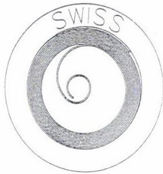
Fig. 4 – Muelle real enrollado, dentro de su arandela, preparado para su colocación
