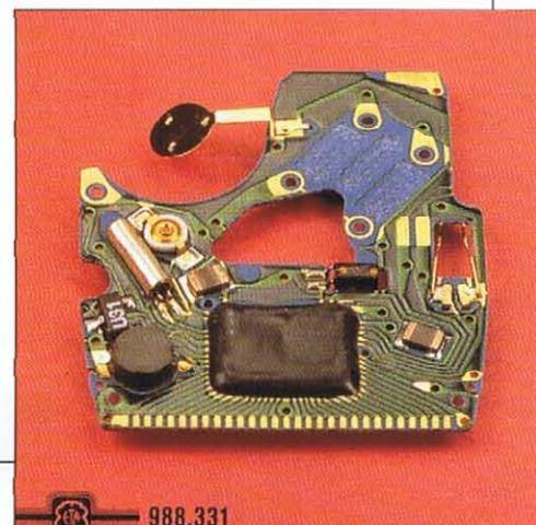
Una vez desmontado de su lugar el circuito impreso, la fotografía muestra el rodaje con las dos bobinas solidarias del motor.
