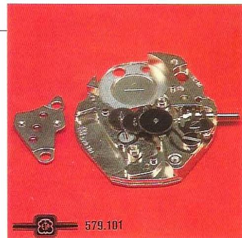
El mecanismo de rodaje en este calibre es muy parecido a los anteriores calibres de ETA. Mirando la foto vemos el puente de rodaje fuera del reloj, con los rubíes rojos y las ruedas en su posición correcta en la platina.
