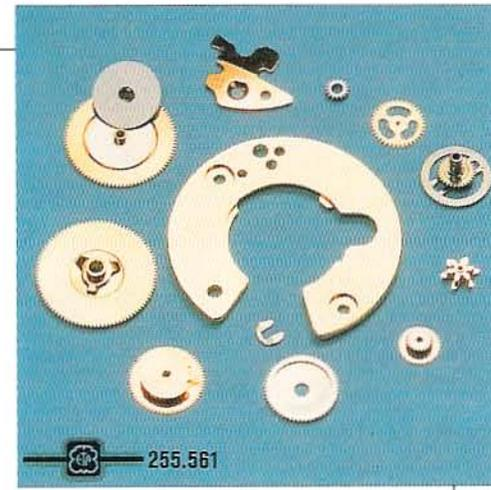
**L**a foto muestra el rosaje de minutería y de calendario y, en el centro, el puente de calendario que mantiene todo el puente sujeto.
