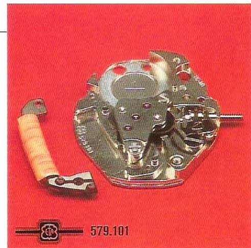
Si sacamos la bobina de la platina vemos con detalle las dos pistas de contacto con el circuito impreso.
