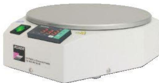
El test de control de la condensación básicamente consiste en calentar el reloj con las placas anteriormente mencionadas y producir seguidamente una inversión térmica con agua fría, si en el interior del reloj queda humedad se refleja en forma de condensación.
