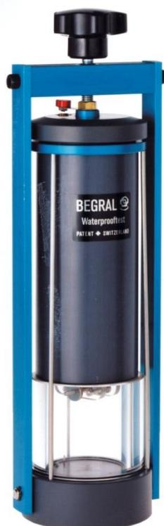
**Modo de empleo:** Conectar la bomba al aparato, llenar el deposito trasparente con agua destilada y colocar el reloj solo con la caja en el soporte trasparente.
