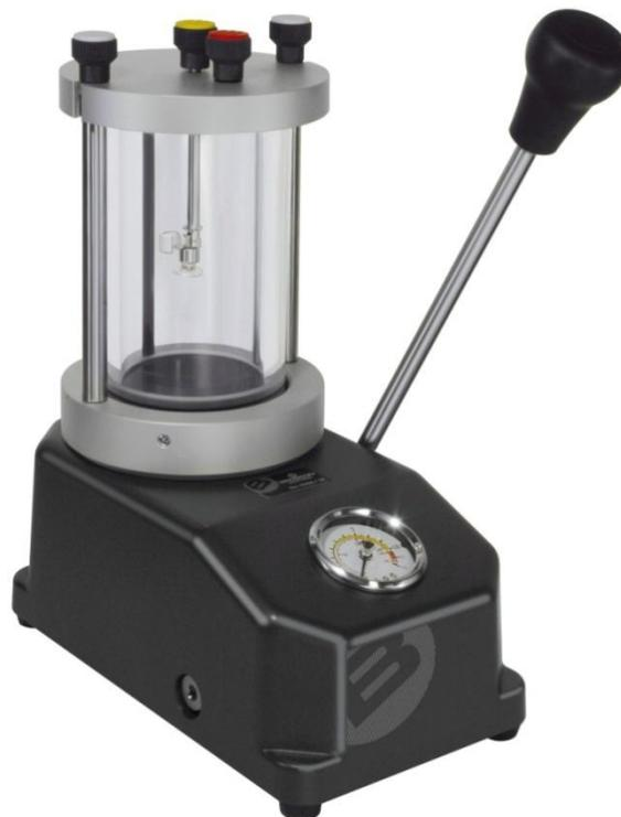
Aparato tradicional de control e la impermeabilidad con la nueva versión de hasta 11 atm, la primera puede verificar entre 3-6 atm.
