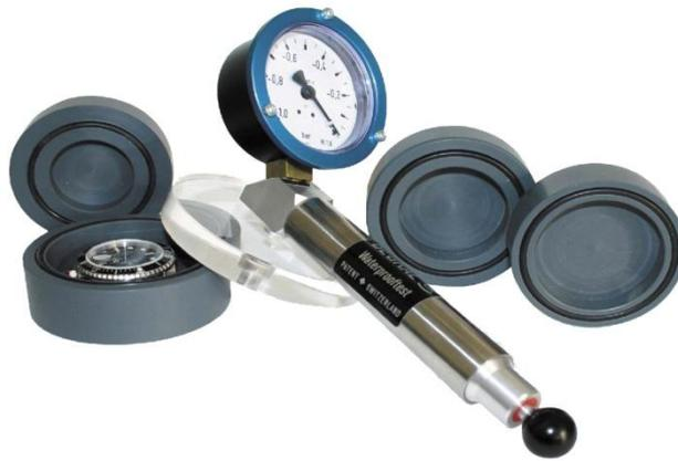
**Modo de empleo:** Para utilizarlo, basta con colocar el reloj en la cámara apropiada por su tamaño, presionar bien para que cierre hermético y estirar de la bola negra.
