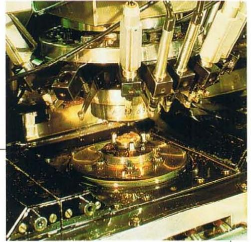
**P**ara finalizar este esquemático recorrido por el *transfer*, un primer plano de la platina del futuro reloj en el centro.
